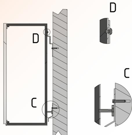
Achten Sie auf den korrekten Einbau des Moduls.
